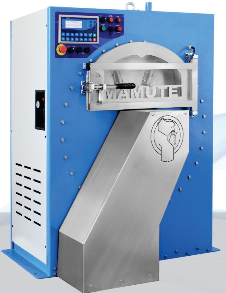
Lavadora Extratora com Barreira Sanitária, projetada para lavar roupas com alta tecnologia e baixo custo operacional. Equipamento compacto, fabricado para ser utilizado até nas menores lavanderias.
